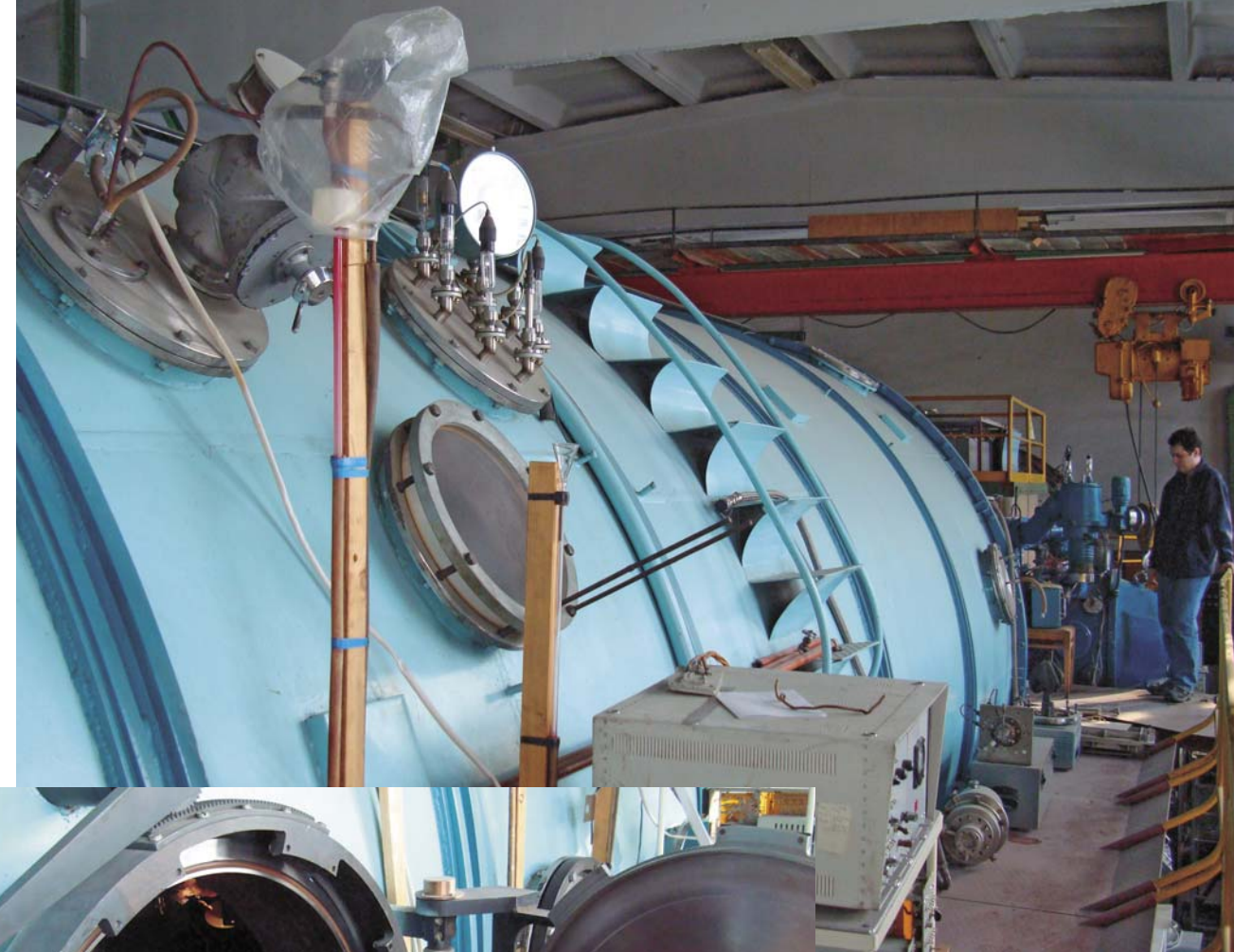
Крупнейшая вакуумная установка «Викинг» Института теплофизики СО РАН имеет диаметр более 4 м и длину около 12 м. Здесь проводят опыты по истечению газа в космический вакуум (давление P < 10^{-6} атм)
