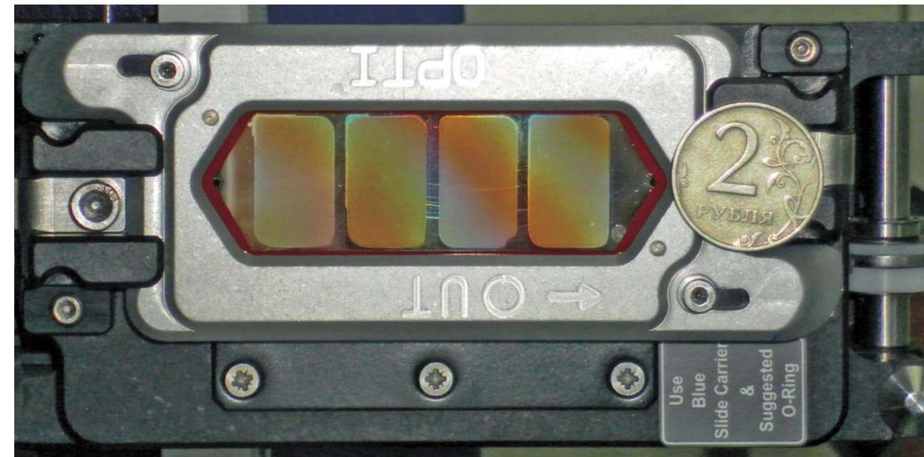
Все существующие технологии массового параллельного секвенирования ДНК основаны на одновременной расшифровке коротких нуклеотидных последовательностей в миллионах микроскопических реакционных областей. На фото – проточная ячейка геномного секвенатора SOLiD. В каждом из четырех коричневых пятен – по 90 млн индивидуальных реакционных областей. Фото Е. Бреннера
